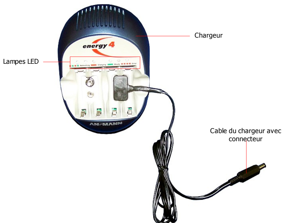
Figure 6: Le chargeur et ses éléments
