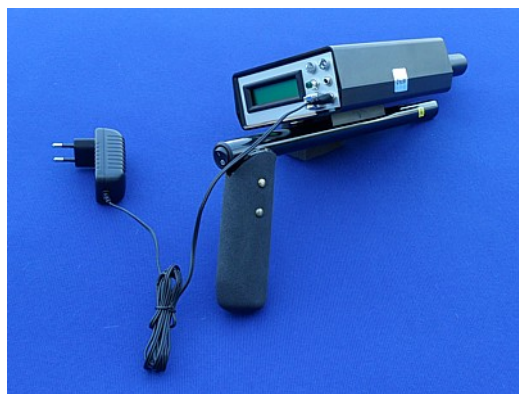
Abbildung 8.2: Anschluss des Ladegeräts
